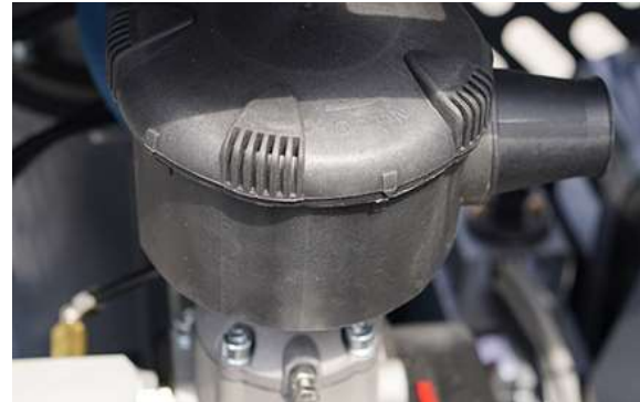
空滤 Air filter 从进入压缩机的空气中去除杂质和颗粒物
