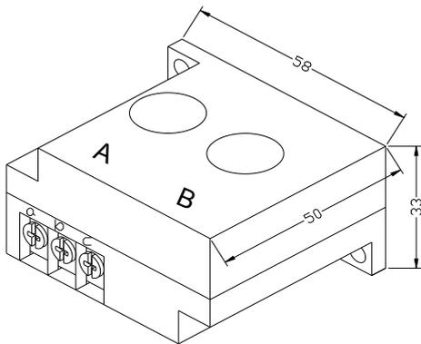
图 4.1.3、CT2 结构尺寸（ $\phi 10$  穿孔）
