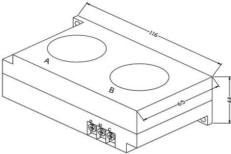
图 4.1.1、CT1 结构尺寸（ $\phi 36$  穿孔）
