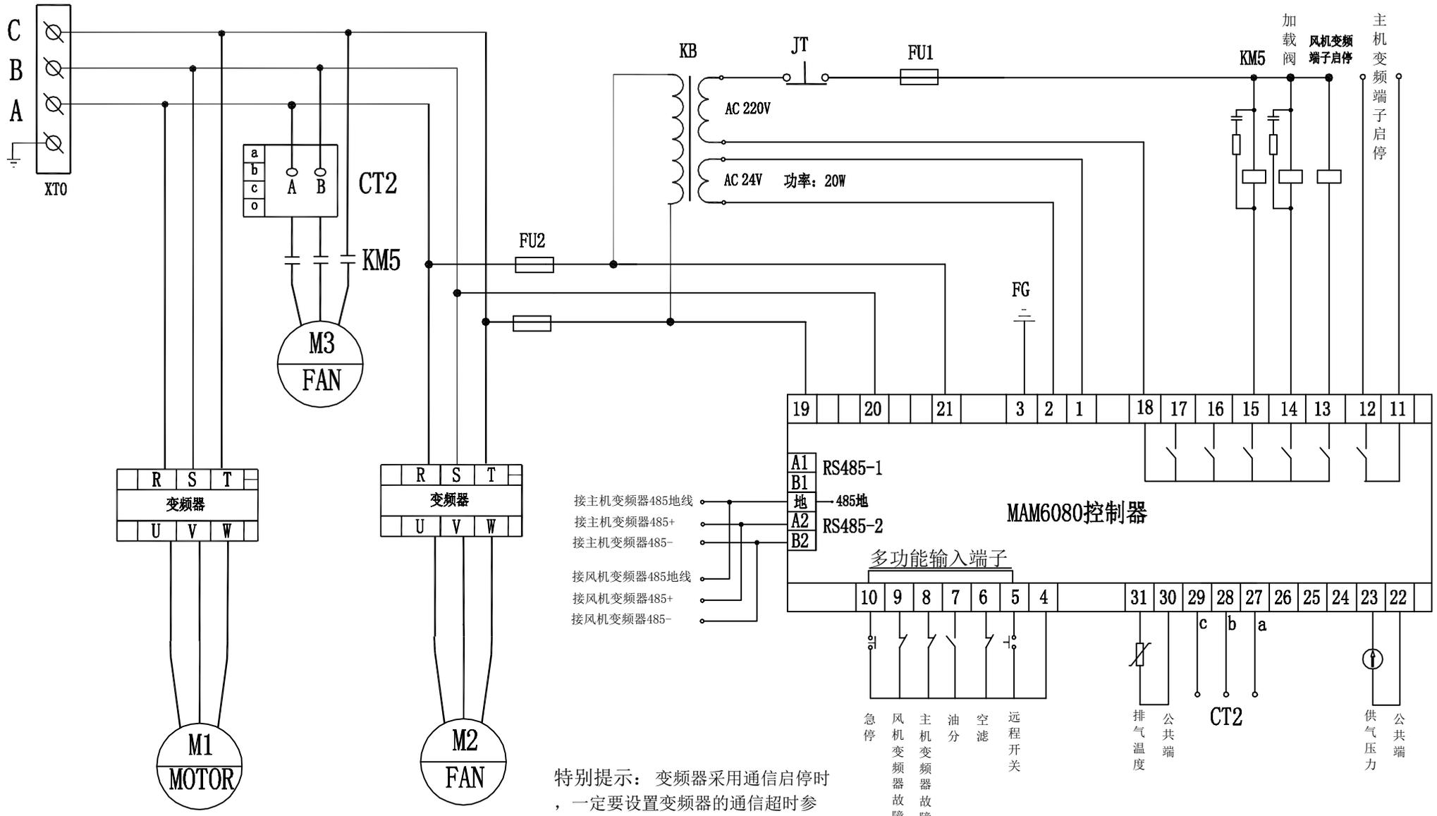
特别提示：变频器采用通信启停时，一定要设置变频器的通信超时参数，建议设为20秒，超过设置时间未收到数据，变频器报故障停机；
