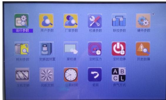
点击供气方式，进入如下图所示界面，用户可根据需要，选择合适的调速方式。
